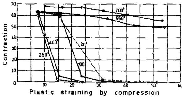
FIG. 17. EMBRITTLEMENT OBTAINED BY STRAINING AT HIGH TEMPERATURES.<sup>3</sup> OPEN-HEARTH STEEL.
