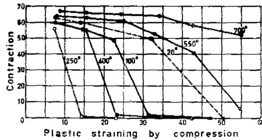
FIG. 18. EMBRITTLEMENT OBTAINED BY STRAINING AT HIGH TEMPERATURES.<sup>8</sup> BASIC BESSEMER STEEL.
